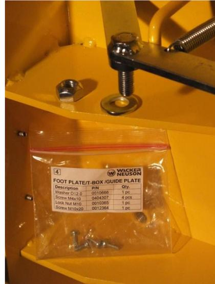
Поместите педаль тормоза в продольное отверстие тележки основания. Совместите педаль с крепежным штифтом тормозной системы и закрепите при помощи Гайки М10и шайбы D 12.0
