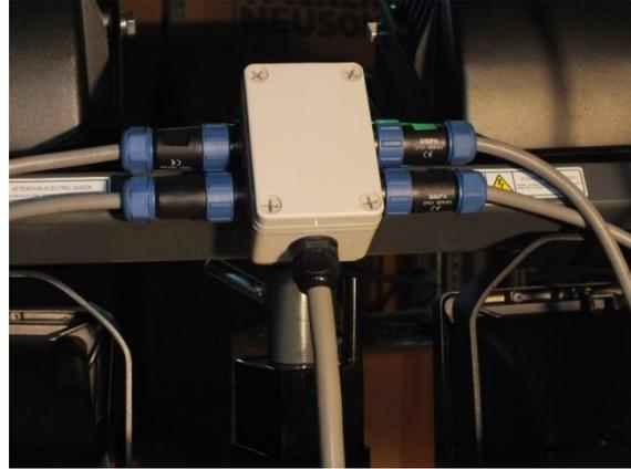
Соедините разъемы прожектора и распределительной коробки. Для позиционирования разъемов используйте белые точки метки на разъемах
