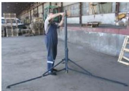
Мачта осветительная может быстро устанавливаться на местности при помощи треног, мобильных опор или может монтироваться стационарно на борт автомобиля или другой строительной техники.
